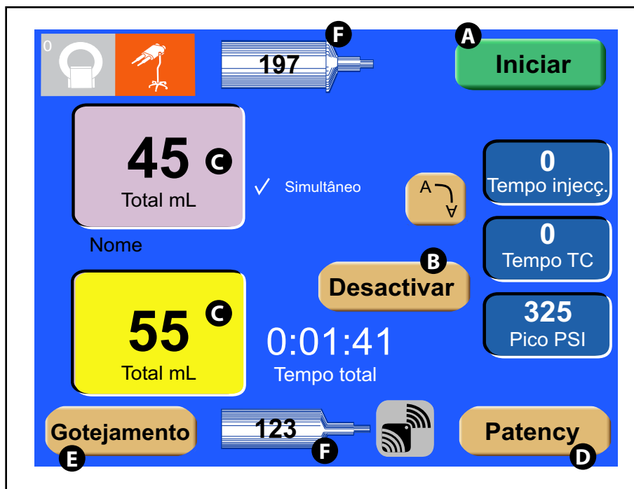
Figura 3-2-15a Teclas e definições da tela Principal ativada da Cabeça motorizada: Modo Monopaciente
