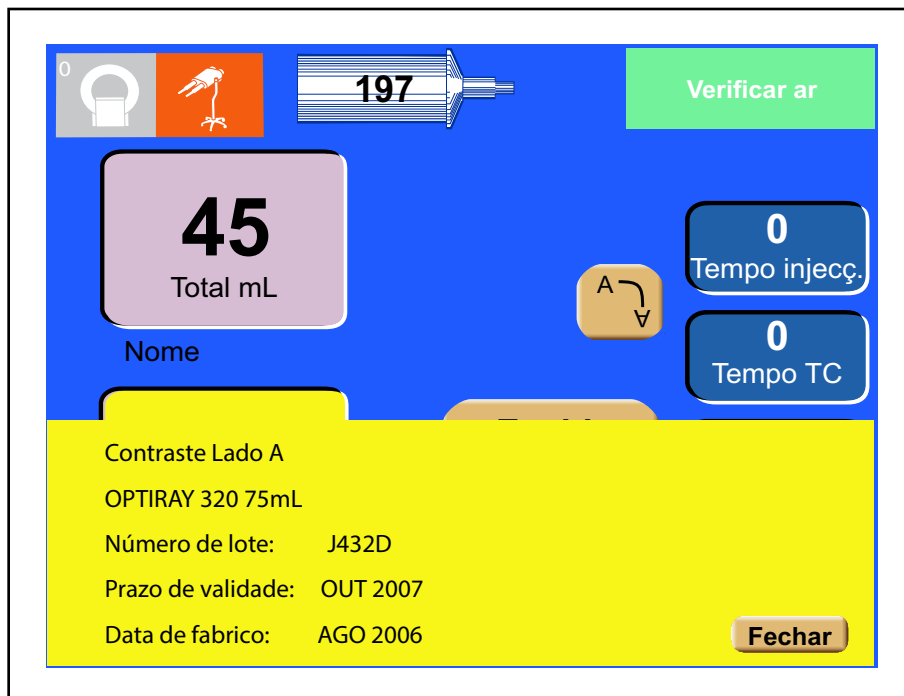
Figura 3-2-8 Informações da seringa com RFID (Modo Monopaciente)
